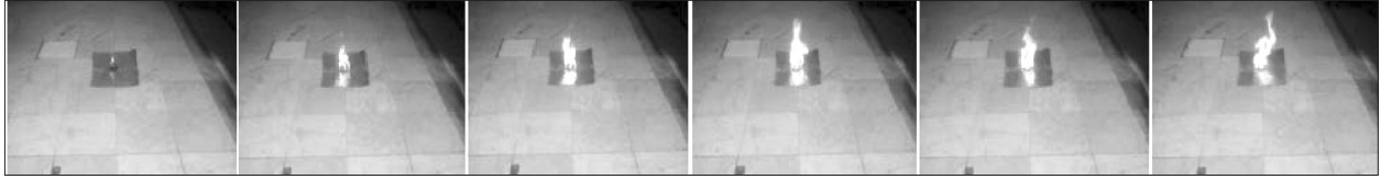
شکل ۵: نمونه‌ای از پایگاه داده شعله در دومین فاصله از دوربین (اندازه شعله از تصویر از چپ به راست رو به افزایش است).
