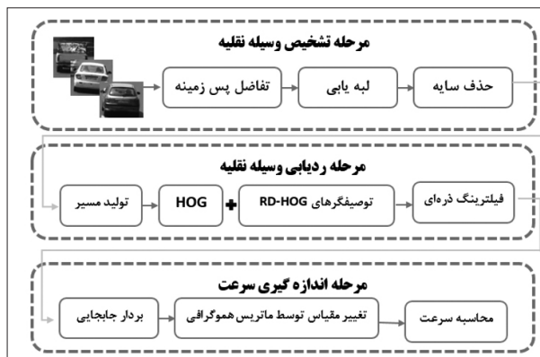
شکل ۱: نمودار روش پیشنهادی برای اندازه‌گیری سرعت خودروها
