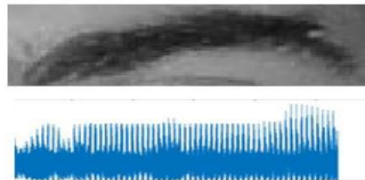
شکل 3: بردار ویژگی‌های استخراج شده از ابرو چپ یک چهره همراه خروجی توصیفگر هیستوگرام گرادین‌های جهت‌دار
